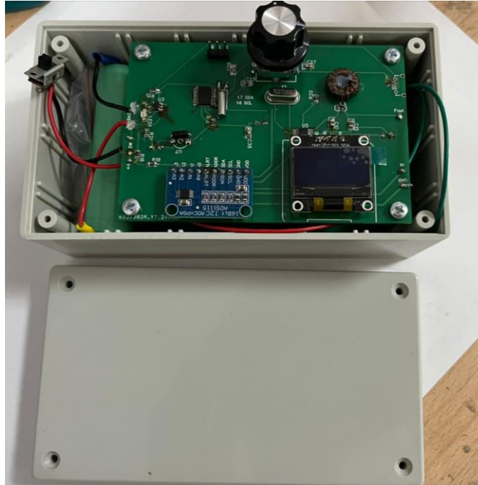
Рисунок 3.25 - Приемник амплитуды сверхдлинных электромагнитных волн
