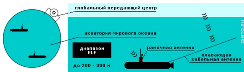
Рисунок 2.10 – Схема радиообмена с подводной лодкой в диапазоне ELF/СНЧ
