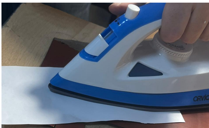
Рисунок 3.13 - Прогревание напечатанной платы, для того что бы краска прилипла к текстолиту
