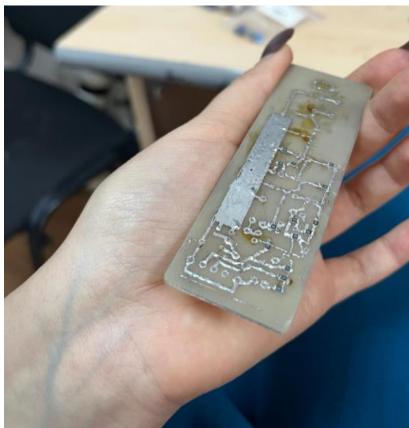
Рисунок 3.18 - Припаянные SMD детали
